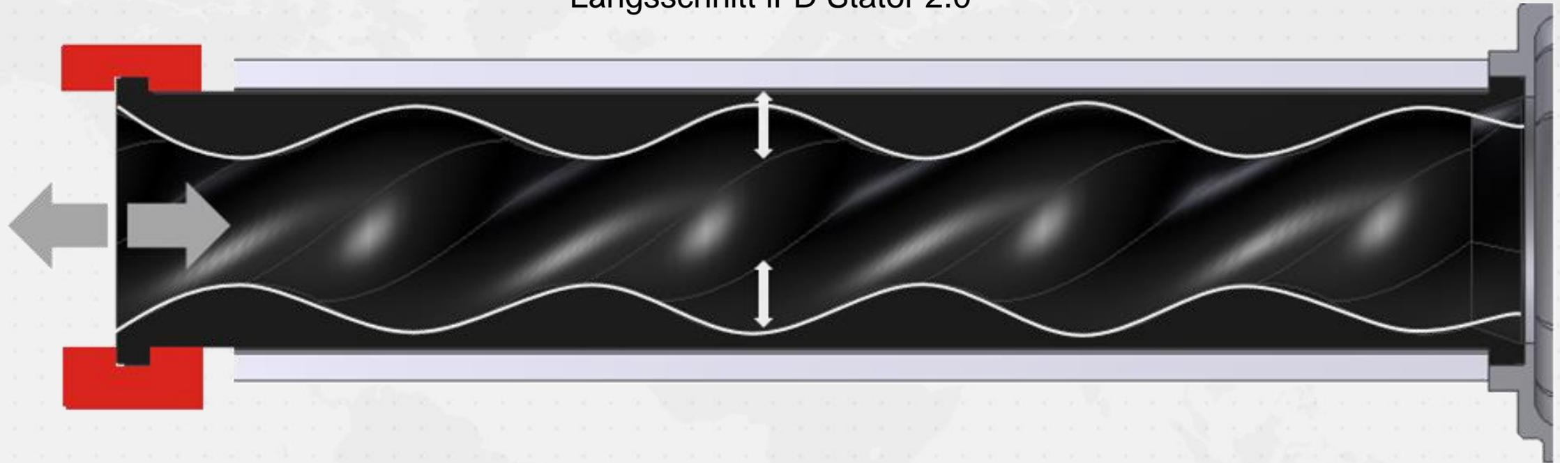
Die über die xLC-select ausgelöste Bewegung des Verstellflansches staucht oder zieht das Elastomerteil im iFD-Statorgehäuse. Da es nur nach innen ausweichen kann, wird der Verschleiß kompensiert. Die Trennung von Elastomer und Mantel bewirkt, dass sich dieser Ausgleich über die gesamte Länge des Stators verteilt und eine gleichmäßige neue Dichtlinie entsteht, die für optimale Pumpenperformance sorgt.
