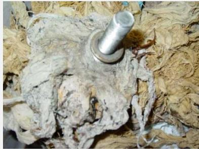
Bild 14: Verzopfung an der Laufradschraube
