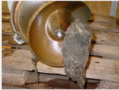
Bild 22: Verstopfung an der Schaufelspitze
