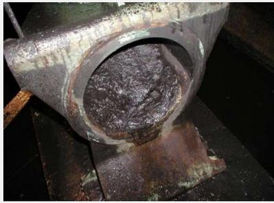
Bild 43: unzureichende Strömungsgeschwindigkeit
