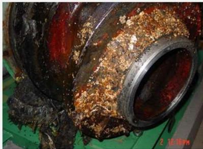
Bild 18: Verstopfung im Bereich Deckscheibe - Spalt
