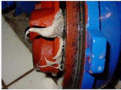
Bild 10: Verstopfung hinter dem Laufrad
