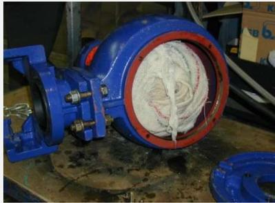
Bild 13: Hydraulik voller Putztücher
