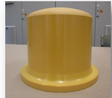
Spalttopf: ZrO<sub>2</sub> / Magnet: 13E02 / Betrieb gegen geschlossene Druckseite Q<sub>0</sub>
