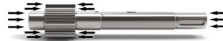
Kräfte an der vollständig gekapselten Antriebswelle
