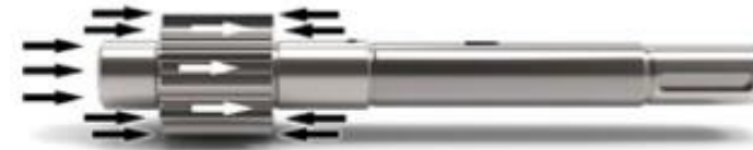
Kräfte an der einseitig herausgeführten Antriebswelle
